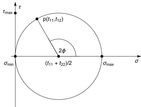
Slika 1: Mohrova krožnica. Levo  $t_{11} > t_{22}$ , desno  $t_{11} < t_{22}$ .
