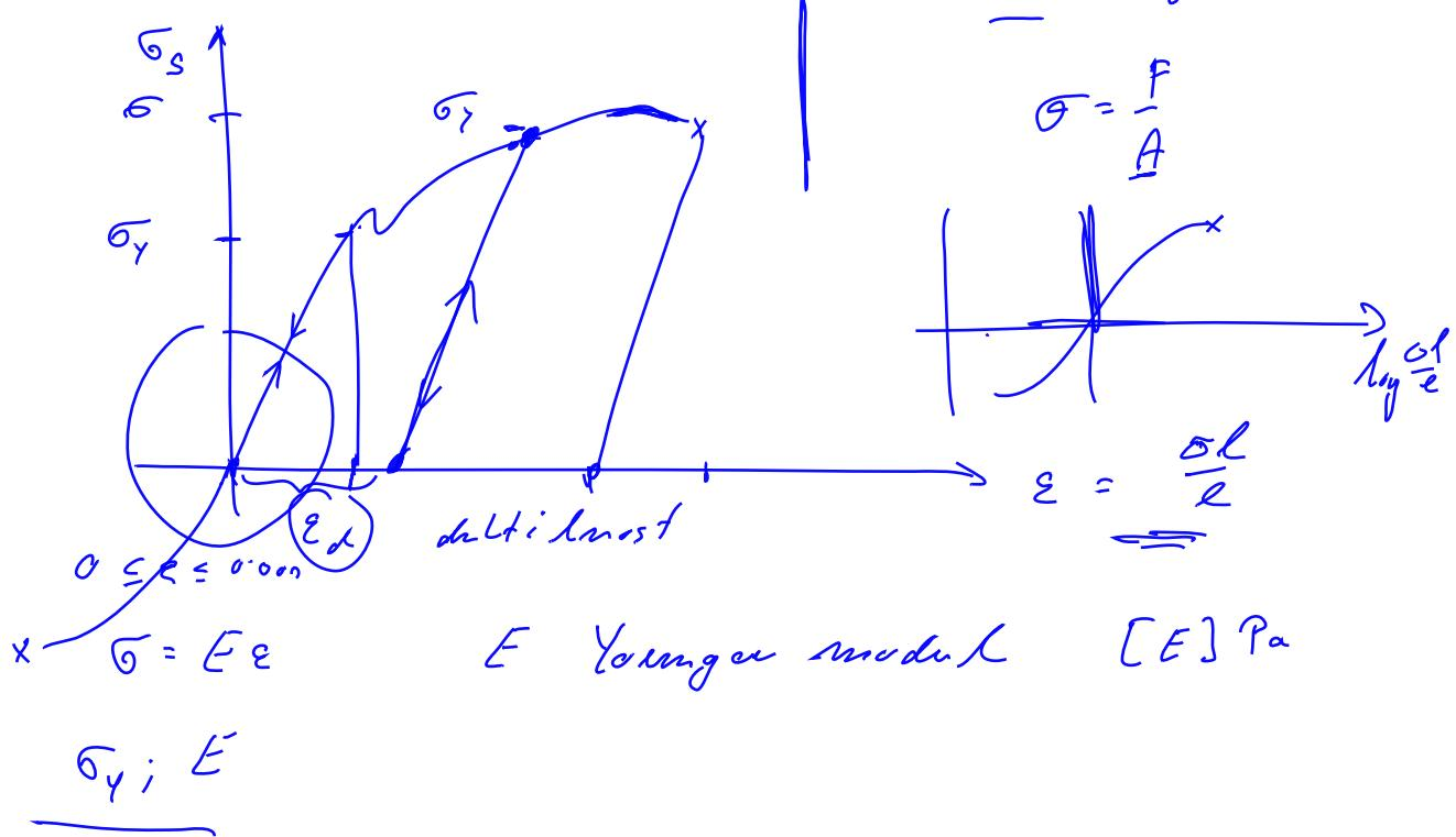
Značilne točke in območja na deformacijsko napetostnem diagramu.
