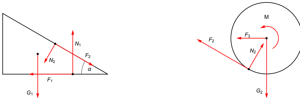
Slika 10: Diagram sil na prosti telesi, zagozda in valj.
