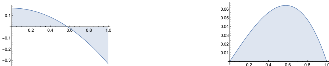
Slika 5.10: Prečna sila in upogibni moment za linearno linijsko obremenitvijo. Slika je brezdimenzijska, abscisa je x/l , ordinata pa 1/q_0l oziroma 1/q_0l^2 .
