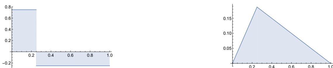
Slika 5.6: Prečna sila in upogibni moment točkovne obremenitve pri a = l/4 . Slika je brezdimenzijska.
