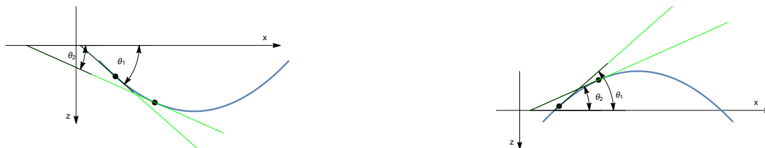
Slika 2: Tangenta na nevtralno os. Levo: upogib v smeri osi z , kot tangente pada z naraščajočim x , \theta_1 > \theta_2 . Desno: upogib v negativni smeri osi z , kot tangente narašča z x , \theta_1 < \theta_2 < 0 .
