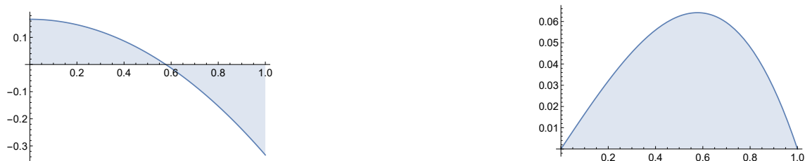
Slika 10: Prečna sila in upogibni moment za linearno linijsko obremenitvijo. Slika je brezdimenzijska, abscisa je x/l , ordinata pa 1/q_0l oziroma 1/q_0l^2 .
