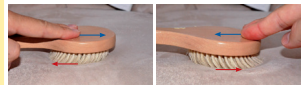
Slika 3.33: Smer sile lepjenja (ali trenja) je narisana z rdečo puščico in nasprotuje sili, s katero skuhamo telo spraviti v gibanje (modra puščica). Smer sile lahko razberemo tudi iz usmerjenosti ščitin na kraku.
