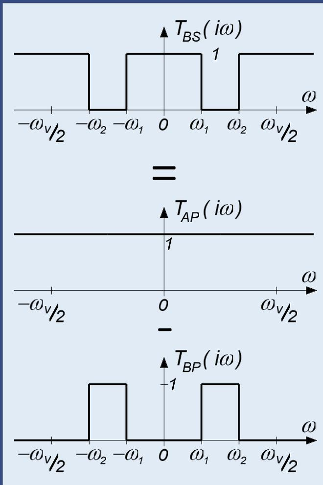
$$T_{BP}(i\omega) = \begin{cases} 0 & \text{za } |\omega| \text{ med } \omega_1 \text{ in } \omega_2 \\ 1 & \text{drugje} \end{cases}$$
