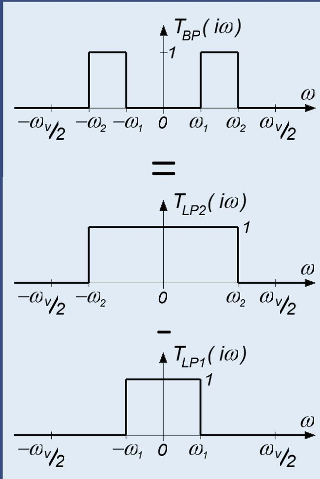
$$T_{BP}(i\omega) = \begin{cases} 1 & \text{za } |\omega| \text{ med } \omega_1 \text{ in } \omega_2 \\ 0 & \text{drugje} \end{cases}$$
