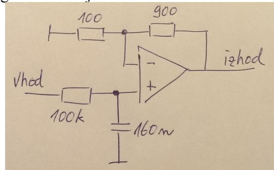
4. Na vhod vezja z narisano ojačevalno karakteristiko je priključen sinusni signal s frekvenco 10kHz in amplitudo 2V. Ocenite amplitudo izhodnega signala.
