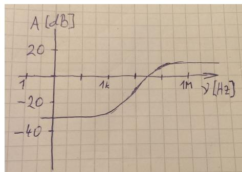
5. Kolikšno je pri frekvenci 16kHz ojačenje narisanega vezja?  $2CR = 1\text{kHz}$ .
