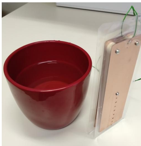
Slika 1: Kondenzator za merjenje višine vode
