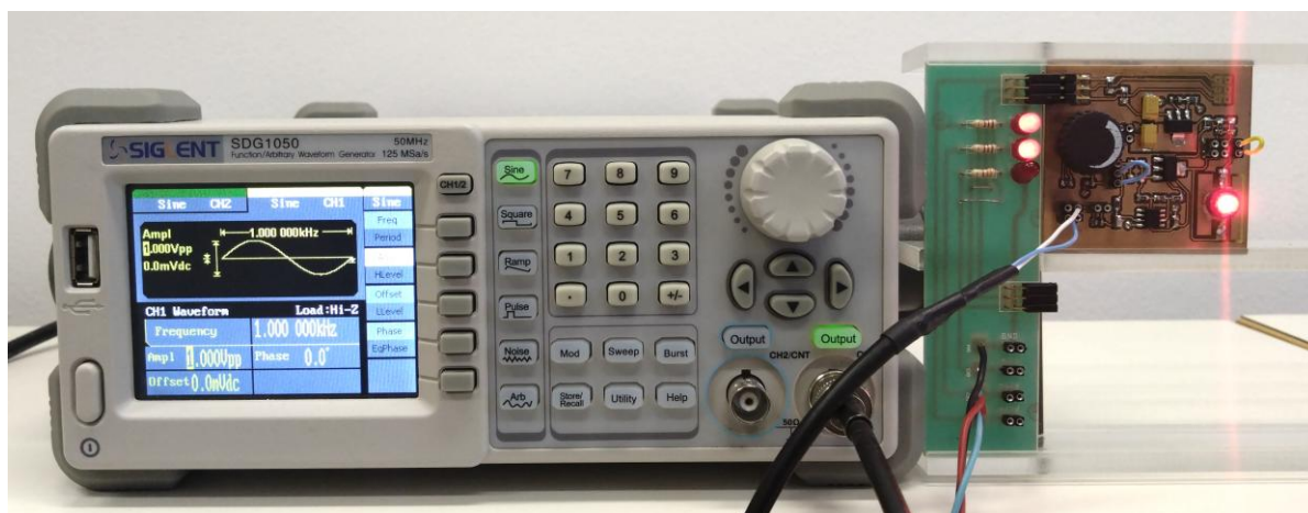
Slika 3: Postavitev generatorja, gonilnika in LED diode
