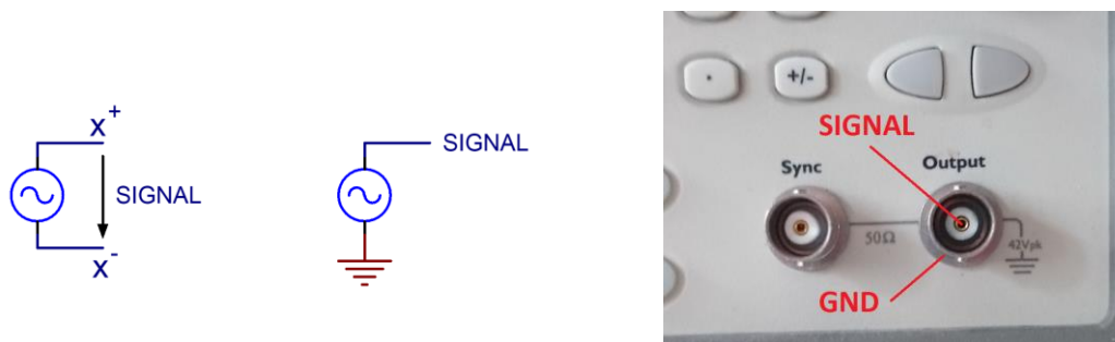
Slika 1: Vir signala ima dve priključni sponki
