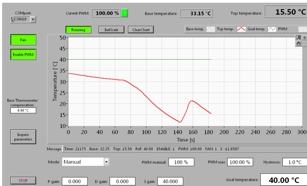
Slika 4: Zaslonska slika programa za nadzor temperature aluminijeve ploščice ALP
